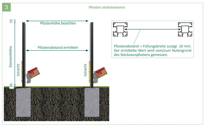
3 | Anschließend die Pfosten setzen und ausrichten. Das Erdloch komplett mit Beton füllen und verdichten. Beton nach Herstellerangaben aushärten lassen.
