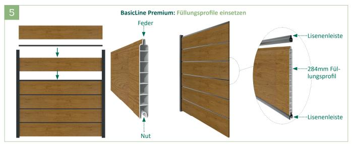
5 | Die Füllungsprofile des BasicLine Premium Elements nacheinander und im Wechsel mit den Lisenenleisten von oben einschieben, dabei die Feder der Füllungsprofile nach oben ausrichten. Mit einem Füllungsprofil beginnen.
