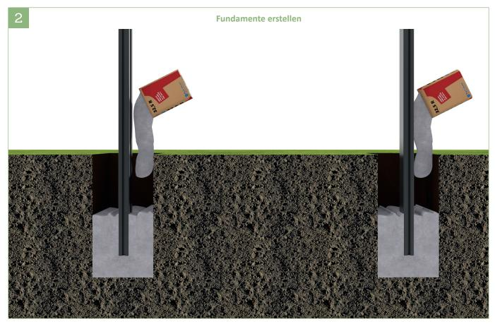
2 | Ungefähr die Hälfte des Erdloches mit Beton füllen und verdichten.
