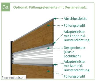
6a | Die Füllungsprofile nacheinander von oben einschieben, dabei die Feder der Füllungsprofile nach oben ausrichten. Bei der Montage des Designeinsatzes vorher die Bürstendichtungen in die Adapterleisten einschieben, dann folgende Reihenfolge beachten: Adapterleiste mit Nut, Designelement, Adapterleiste mit Feder. Danach die verbliebenen Füllungsprofile einschieben und die Abschlussleiste aufsetzen.
