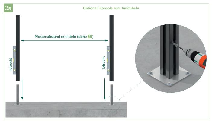
3a | Ausrichtung der Konsolen bei aufgesteckten Pfosten. Zum Befestigen der Konsolen auf den Untergrund die Pfosten entfernen. Zusätzlich kann der Pfosten durch eine Senkkopfschraube fixiert werden. Schrauben sind nicht im Lieferumfang enthalten.
