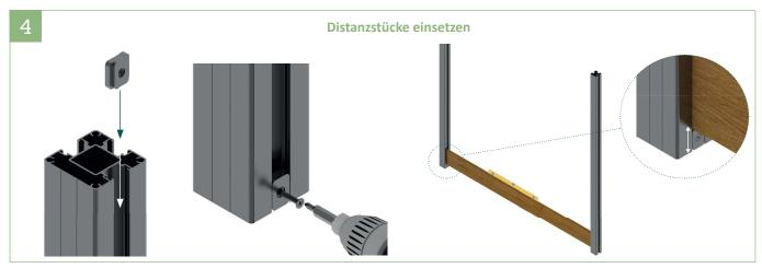
4 | Distanzstück hochkant in die Innenseite der Pfostennut einschieben, bündig mit der Unterkante des Pfostens abschließen, vorbohren und verschrauben. Zuerst auf einer Seite das Distanzstück befestigen. Das Distanzstück der zweiten Seite mit Hilfe eines Füllungselementes und einer Wasserwaage ausrichten und befestigen
