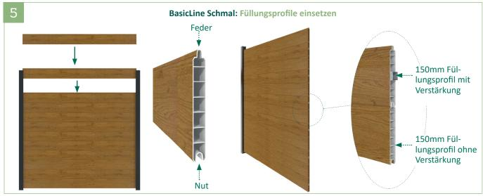
5 | Die Füllungsprofile des BasicLine Schmal Elements nacheinander und im Wechsel (Füllungsprofil mit Verstärkung und ohne Verstärkung) von oben einschieben, dabei die Feder der Füllungsprofile nach oben ausrichten. Mit einem Füllungsprofil inkl. Stahlverstärkung beginnen.
