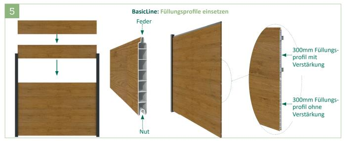
5 | Die Füllungsprofile des BasicLine Elements nacheinander und im Wechsel (Füllungsprofil mit Verstärkung und ohne Verstärkung) von oben einschieben, dabei die Feder der Füllungsprofile nach oben ausrichten. Mit einem Füllungsprofil inkl. Stahlverstärkung beginnen.
