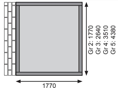
Fundamentplan (in mm) bei Aufbau mit Fußboden:
